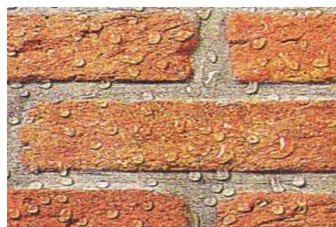
Hydrofoob oppervlak, geen enkele aanzuiging van de kalei
